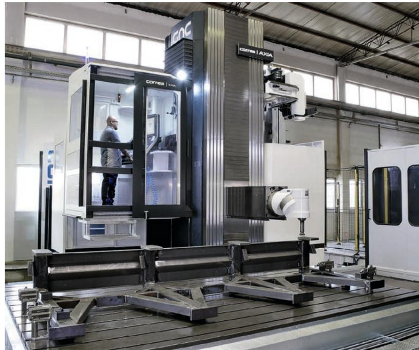
Die Axia-85 hat eine stabile Box-in-Box-Konstruktion und einen Arbeitsbereich von 8.500 mm x 1.750 mm x 3.000 mm.
