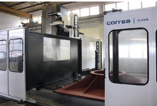
Die Trennwand schafft bei der Axia zwei Bearbeitungsflächen, sodass hauptzeitparallel gerüstet werden kann.
