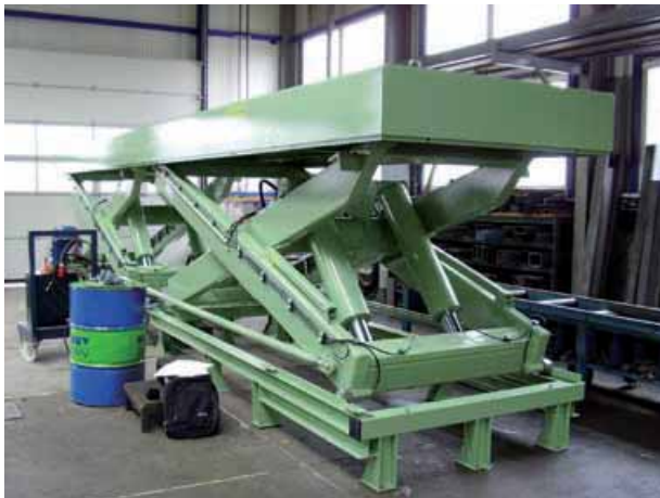
Hubtisch 20 Tonnen Traglast, Plattformgröße 10 x 1,7 m, Hub 2,4 m
