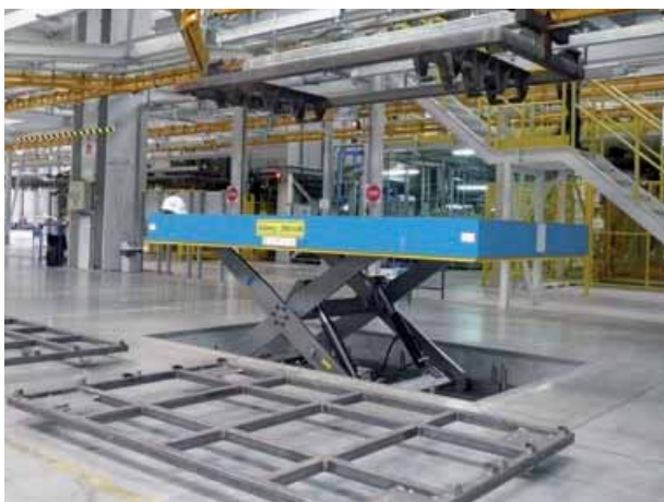
Scherenhubtisch in einer Automobiltaktstraße
