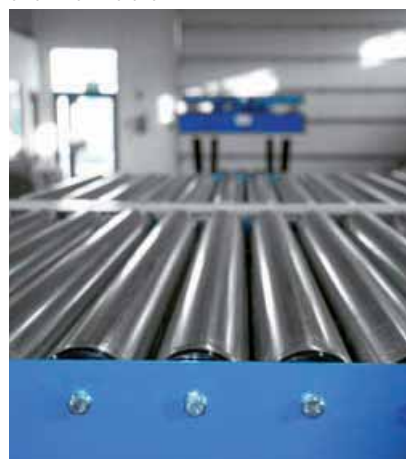
Hubtisch mit Rollenbahn - Einsatz im Versandbereich
