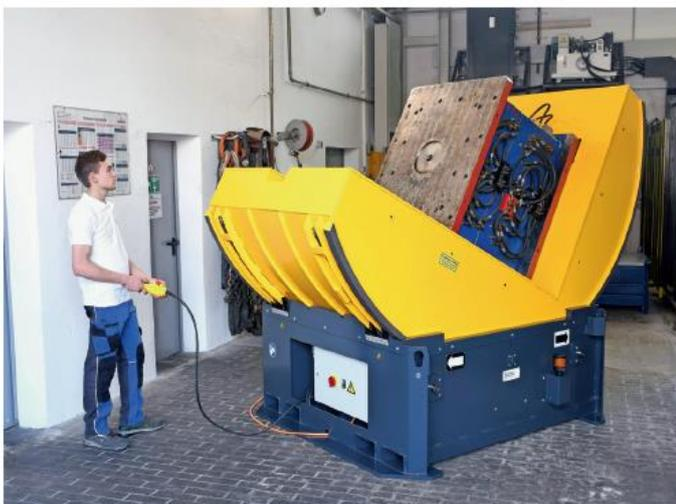
Mit dem Tool Mover Werkstücke bis zu 80 Tonnen sicher wenden.
