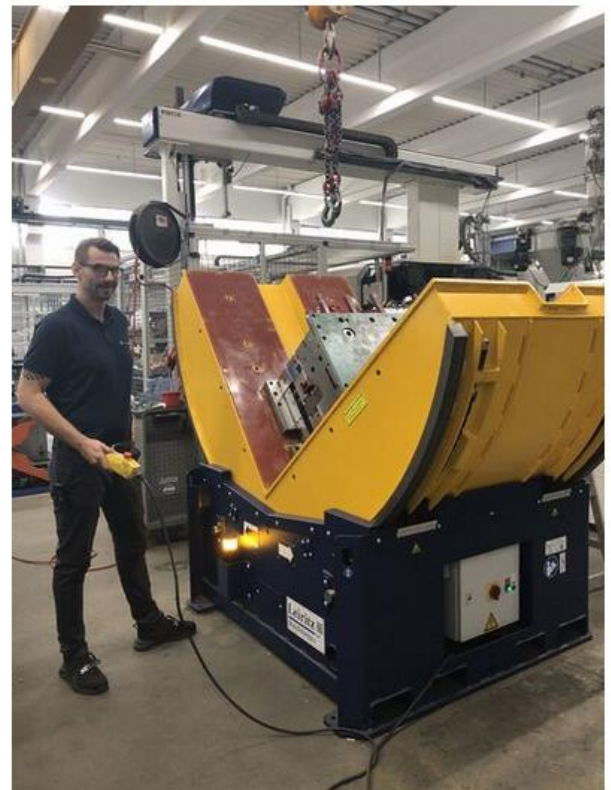
Der Tool Mover ProTECH soll bei Plastro Mayer die körperliche Belastung der Mitarbeitenden reduzieren. - © Leiritz Maschinenbau GmbH
